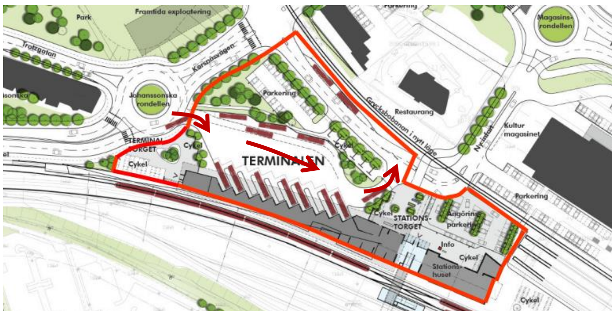
Figur 40. Bussuppställning Falun resecentrum. Genomströmningsprincipen tillämpas där bussarna angör med dockningsprincipen. Pilarna illustrerar körriktning (Falu kommun, 2013).
